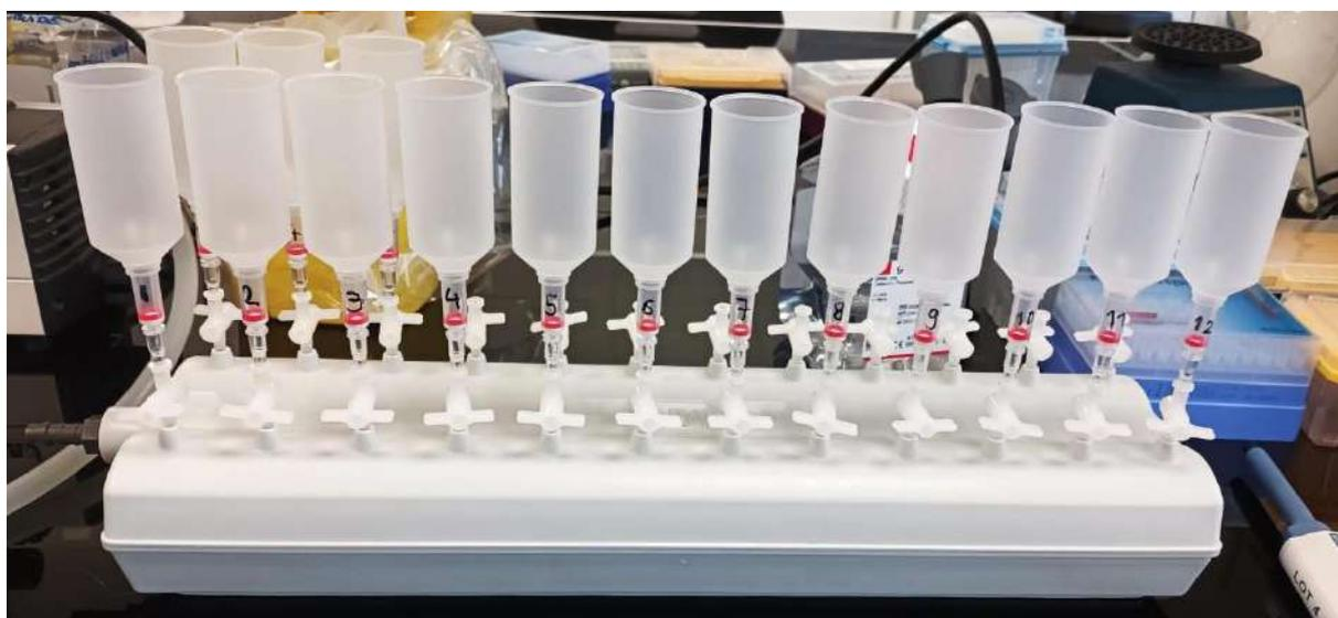
**Figure 52 : Photographie du système d'aspiration utilisé pour l'extraction d'ADN des échantillons plasmatiques de notre cohorte de Bouviers Bernois. Photographie personnelle réalisée au laboratoire de l'Équipe « Génétique du Chien » de l'IGDR.**
