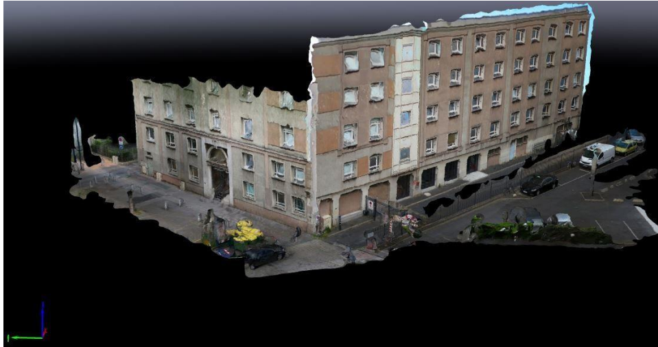
Figure 22 : Maillage texturé obtenu à partir du projet fusionné (Source : production personnelle)
