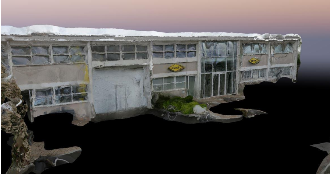
Figure 11 : Maillage 3D texturé obtenu par le mode 360° (Source : production personnelle)
