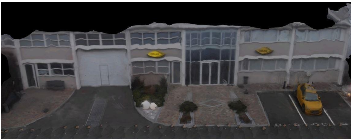
Figure 7 : Maillage texturé obtenu à partir d'un relevé photogrammétrique en utilisant la caméra 360° Ricoh Theta SC2 (Source : production personnelle)
