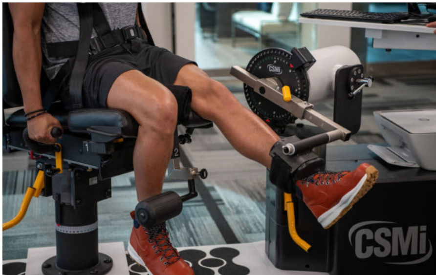
Position du patient au dynamomètre isocinétique
