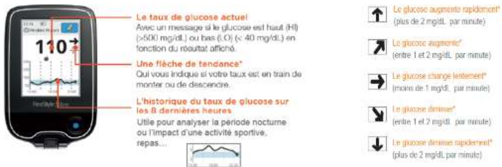
Figure 8 : Iconographie explicative d'un scan en temps réel lors de l'utilisation du FSL
