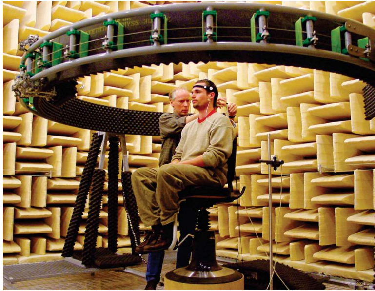
Fig 15 : mesure d'une HRTF utilisée pour l'acquisition de la base Jean-Marie Pernaux (8 sujets dans 965 directions)
