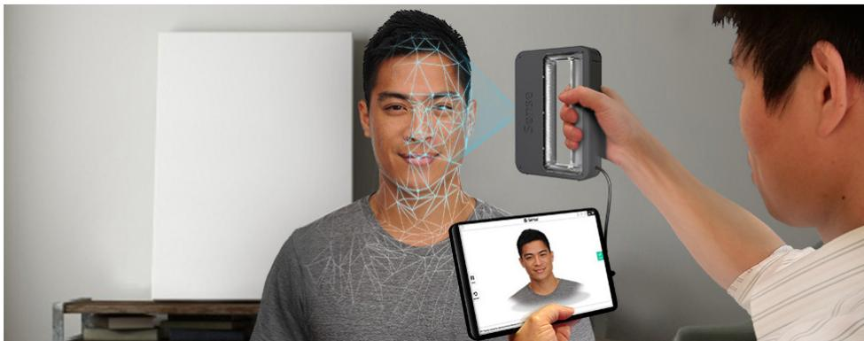
**Figure 11** : Démonstration de l'utilisation du Scanner 3D Sensa v2 (30)
