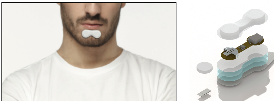
Figure 16 : Mise en place du dispositif et la composition du capteur Sunrise ® (20)
