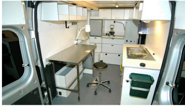
» Peugeot Boxer utilitaire : clinique vétérinaire itinérante installée dans un véhicule utilitaire classique. Table de consultation/chirurgie, espace laboratoire, évier et grand espace de rangement permettant consultations et mêmes petites interventions dans un espace restreint.
