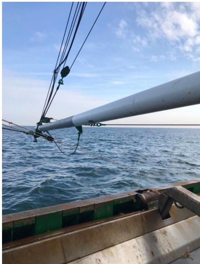
Doc 7-Les perches sont fixées latéralement, ici une perche tire les dragues.
