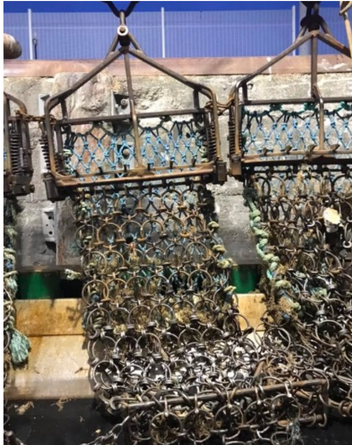
Les dragues font parties des arts traînants (actifs), elles permettent de pêcher des espèces benthiques comme la saint-jacques, la palourde, ou encore les amandes. Photo prise sur le Charles de Foucault III, le 3 mai 2022.
