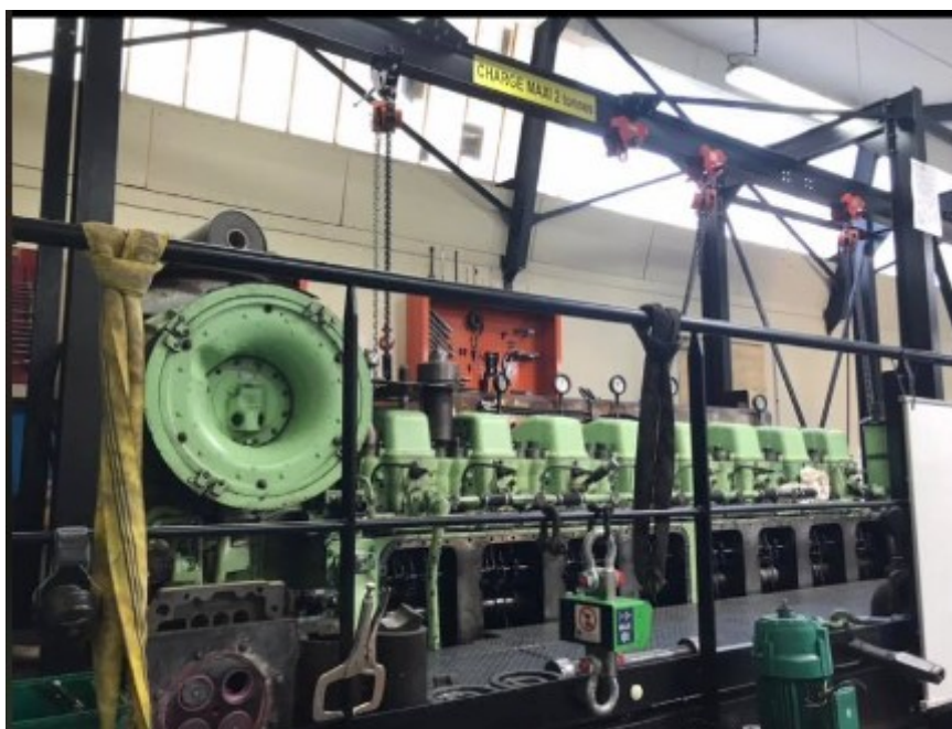
Moteur diesel d'un chalutier des années 1990. Photo prise au lycée professionnel maritime de Boulogne-sur-Mer/Le Portel, le 3 mars 2022.
