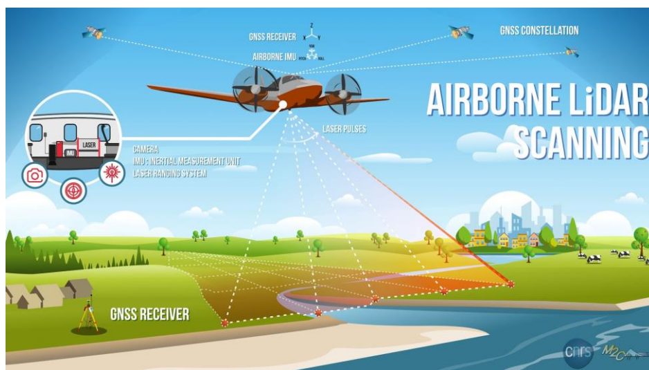
Figure 5 : Le fonctionnement du Lidar aéroporté (M2C)
