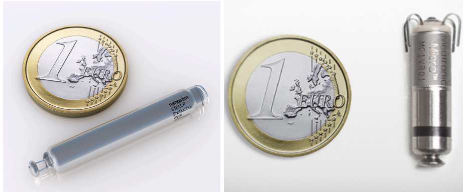
Figure n°11 et 12: Nanostim™ & Micra™
