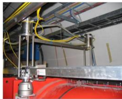
Illustration 2 : Inclinomètre hydrostatique, Shuite J. (2016) [à droite] et Boerez J. (2008) [à gauche].
