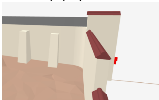
Figure 8 : Chaperons modélisés avec Revit (production personnelle)
