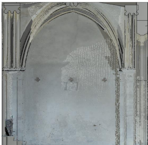
Figure 15 : Nuage de points accolé au modèle BIM
