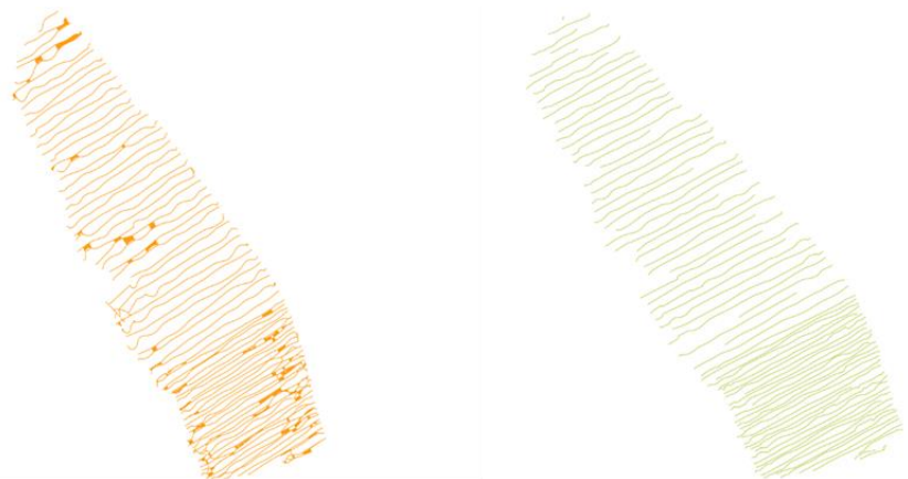
Figure 21 : [En orange] le découpage effectué par l'approche géométrique [en vert] le découpage effectué par l'approche de plus proche voisin
