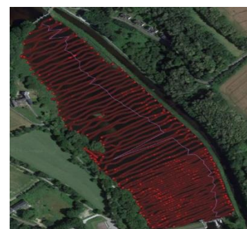
Figure 44 : Semis des points du levé de St-Aignan importé sur QGIS, formant des profils avec la présence d'un axe hydraulique
