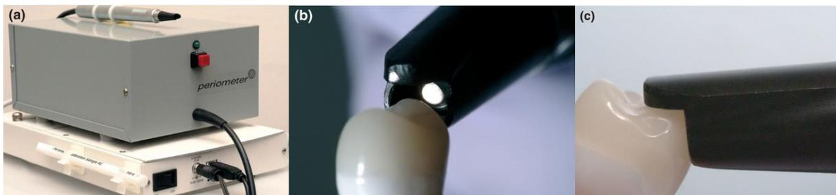
Figure 5.12 : Prototype de pièce à main (Periometer®, Perimetrics CA) avec alimentation (a), détails de l'embout en utilisation *in-vitro* sur une couronne implanto-portée (b) et (c) (Magne et al., 2013)
