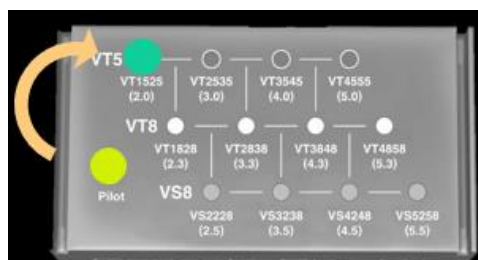
Figure 24 : séquence des forets Passage au foret 2.0
