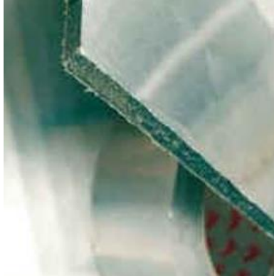
Figure 39 : Vue transversale d'un panneau Energain (44)
