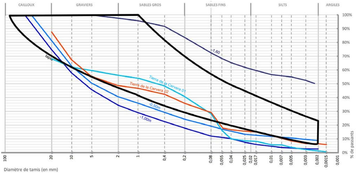
Curvas de la tierras analizadas por Edra y las 3 calicatas del geotécnico. Dos bolsas fueron traídas del sitio.
