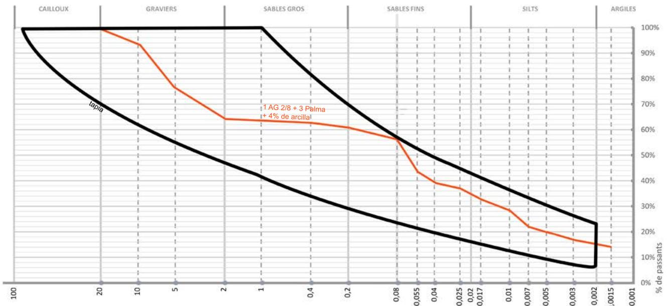
Granulometria de la tierra analizada reformulada con 1 volumen de arido grueso por 3 de la tierra con 4% de arcilla pura agregada
