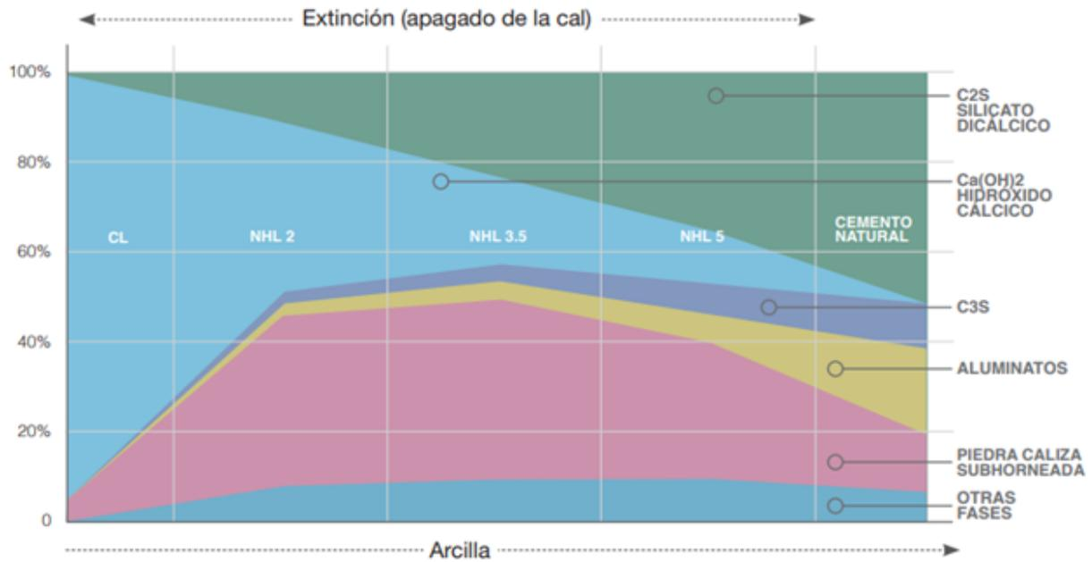
Como se puede observar, la composición mineralógica del Cemento Natural, es la misma que la de las cales hidráulicas, pero en diferentes proporciones.
