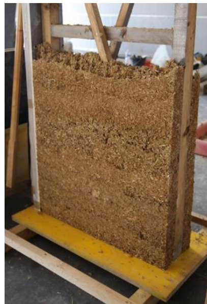
Figure 20 : Réalisation de terre allégée aux grands ateliers dans le cadre des formations Amàco
