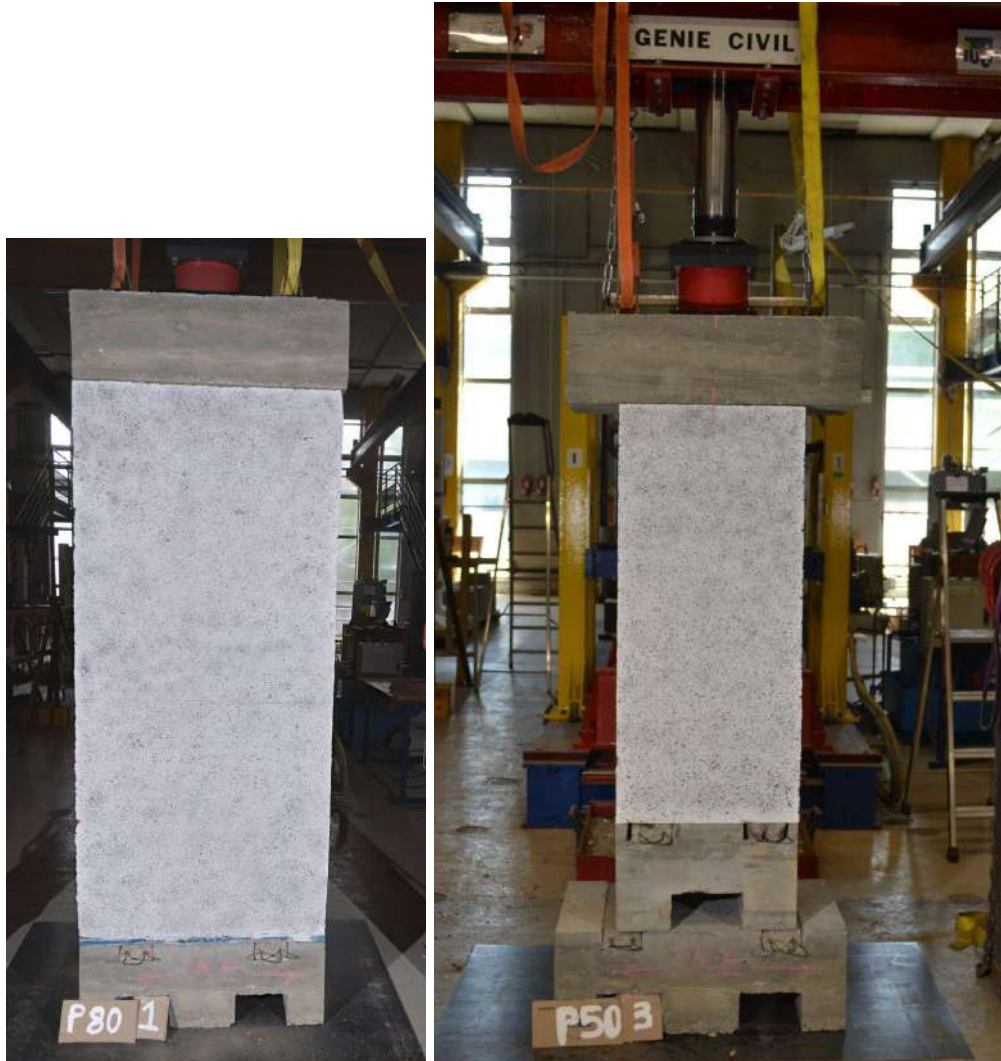
Fig 29: Assemblage du P80 et P50 pour l'essai de compression
