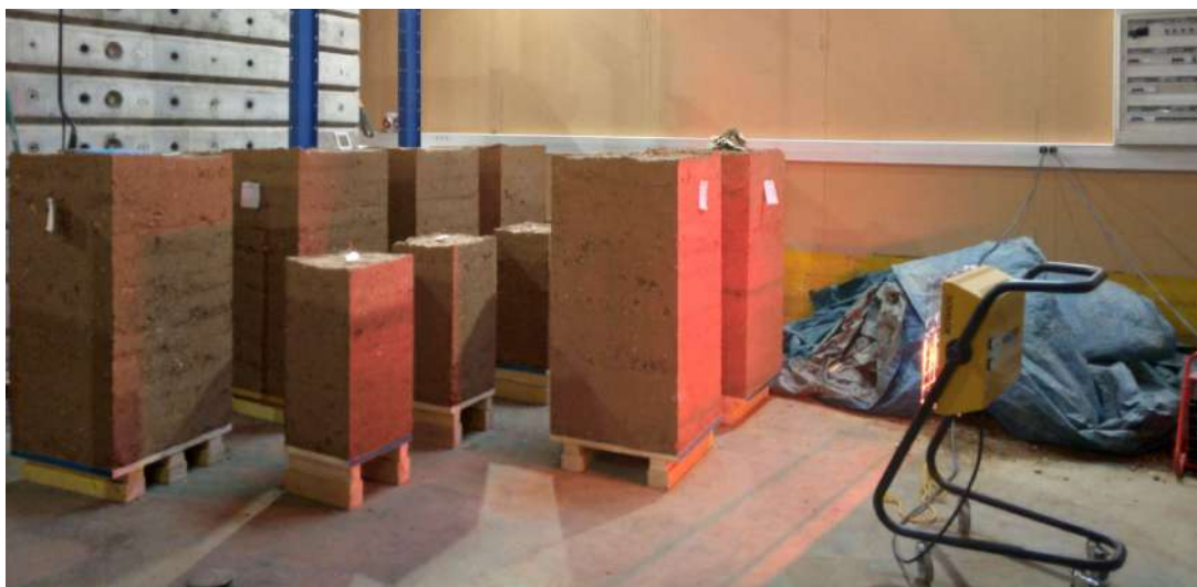
Fig 28: Les échantillons prismatiques séchant dans la salle chauffée
