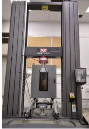
Fig 16 : Essai INSTRON de compression de 100 kN
