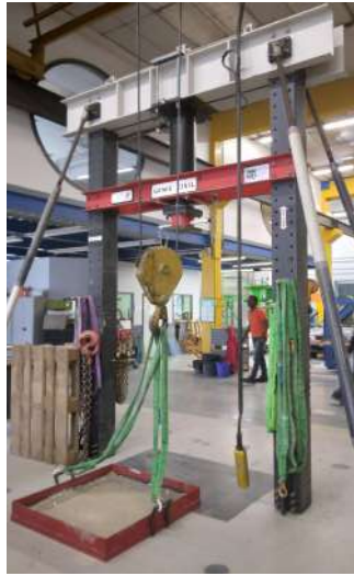
Fig 15 : Presse utilisée pour l'essai uniaxial sur des échantillons prismatiques
