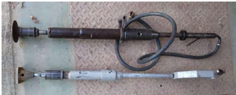
Fig 26: Le fouloir pneumatique utilisé pour les P80, P50 et P30
