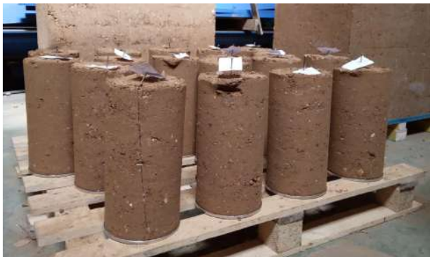
Fig 3 : Échantillons cylindriques fabriqués en laboratoire.
