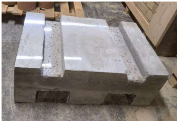
Fig 30: Socle en béton fabriqué pour atteindre la hauteur souhaitée lors de l'essai de compression de P80 et P50.
