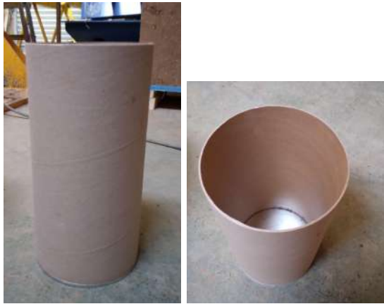
Fig 24: Coffrage en carton (16/32)
