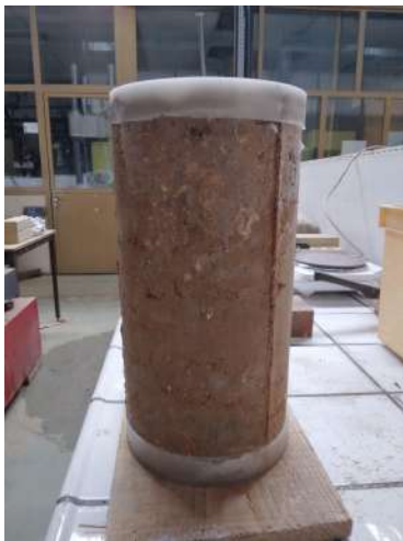
Fig 13 : Surfaçage en cire
