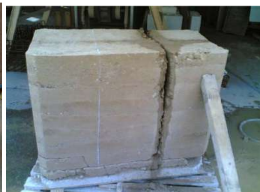
Fig 4 : Découpe d'un muret réalisée sur place et transportée au laboratoire [Bui, Q. B. (2008)].
