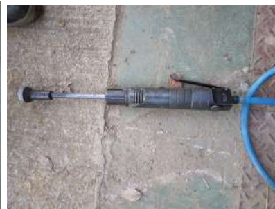
Fig 27: Le petit fouloir pneumatique de P20 et C
