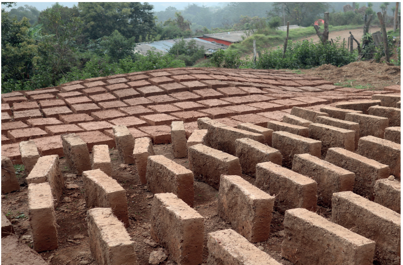
↑ Production locale d'adobe
