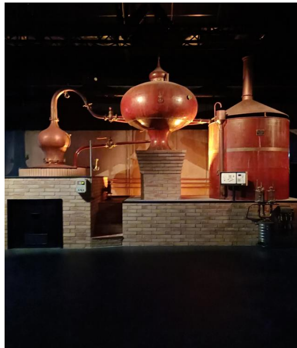
Figure 23 : alambic charentais ou alambic à repasse, Calvados Expérience Calvados Expérience, Pont-l'Évêque © Pierre Le Breton
