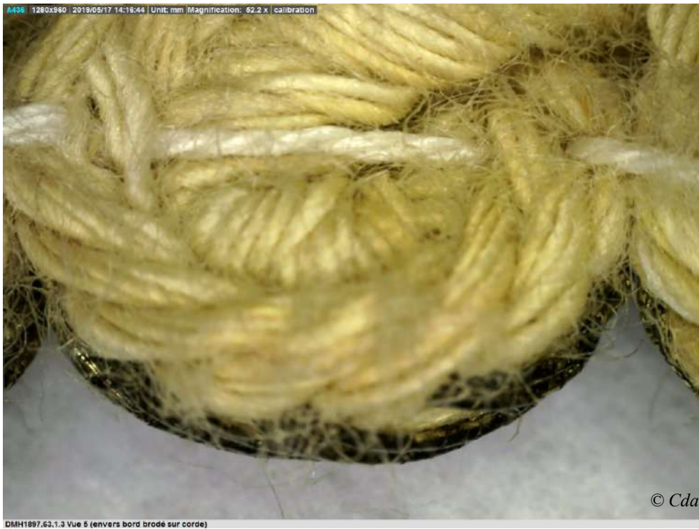
DMH1897.63.1.3 - Vues 1 et 5 - Tresse métallique sur corde (endroit et envers) (52.2x)
