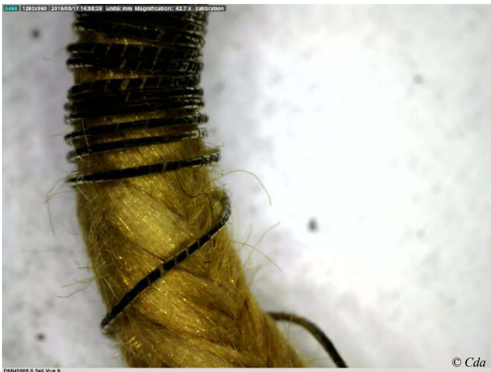
DMH2005.0.246 - Vue 9 - Filé métallique enroulé sur tresse (62.7x)
