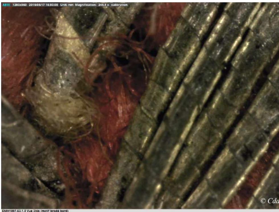
DMH1897.63.1.2 - Vue 3 - Tresse métallique sur corde (245.5x)
