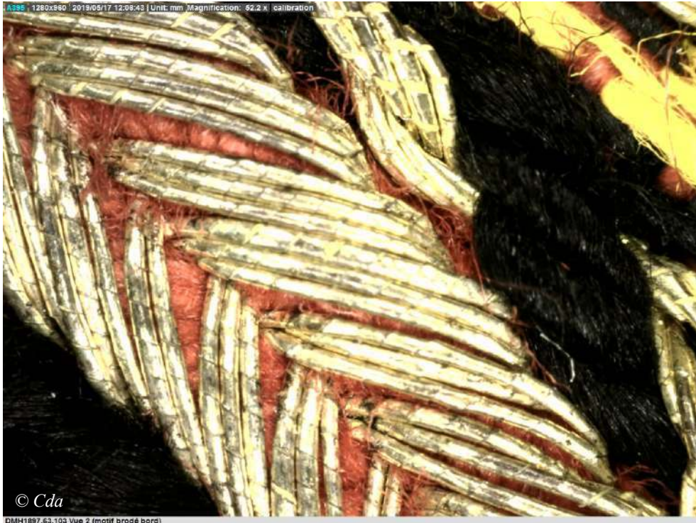
DMH1897.63.10.3 - Vue 2 - Tresse métallique à chevrons sur corde (52.2x)
