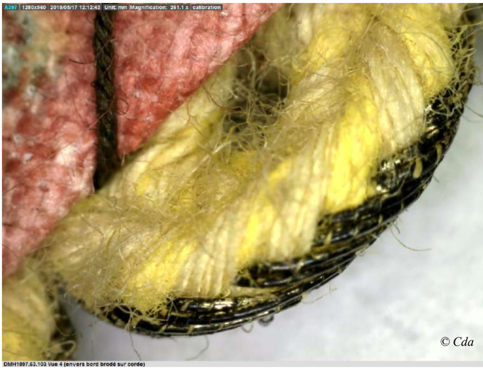
DMH1897.63.10.3 - Vues 1 et 4 - Tresse métallique sur corde (endroit et envers) (52.2x)
