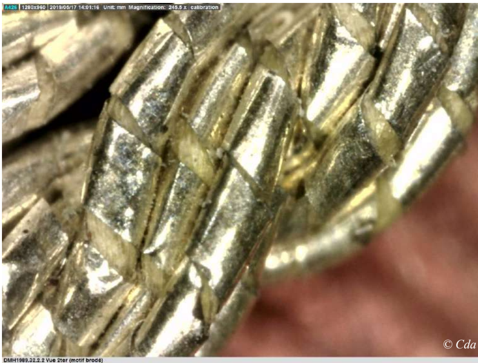
DMH1989.32.2.2 - Vue 2 - Cordonnets métalliques (broderie de type zerduz) (261.1x)
