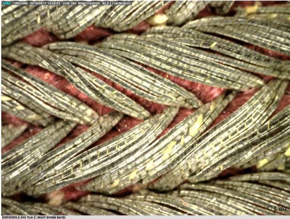
DMH2005.0.246 - Vue 2 - Tresse métallique à chevrons sur corde (52.2x)
