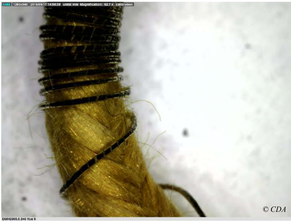
DMH2005.0.246 - Vue 9 - Filé métallique enroulé sur tresse (62.7x)
