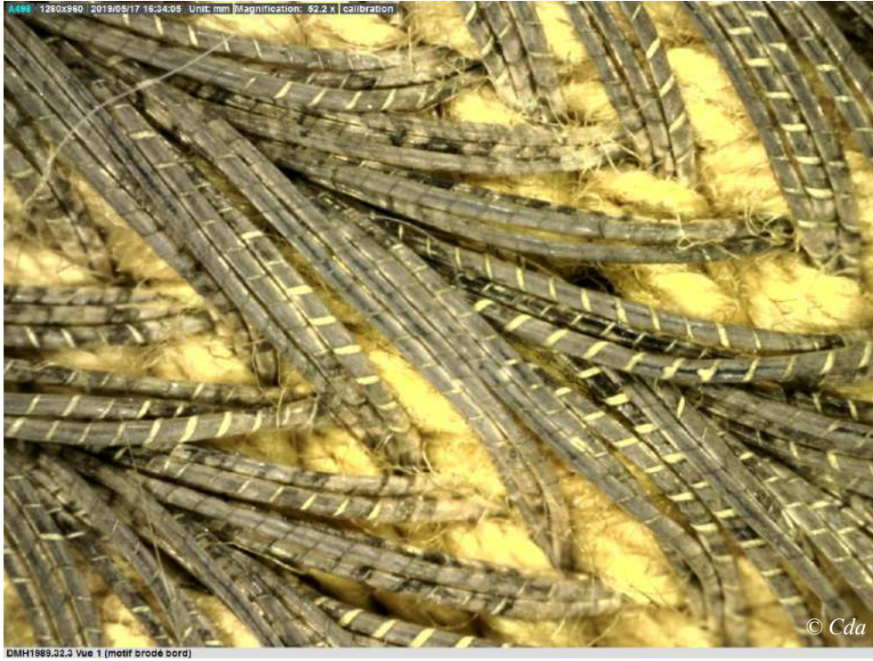
DMH1989.32.3 - Vue 1 - Tresses métalliques à chevrons sur corde (52.2x)
