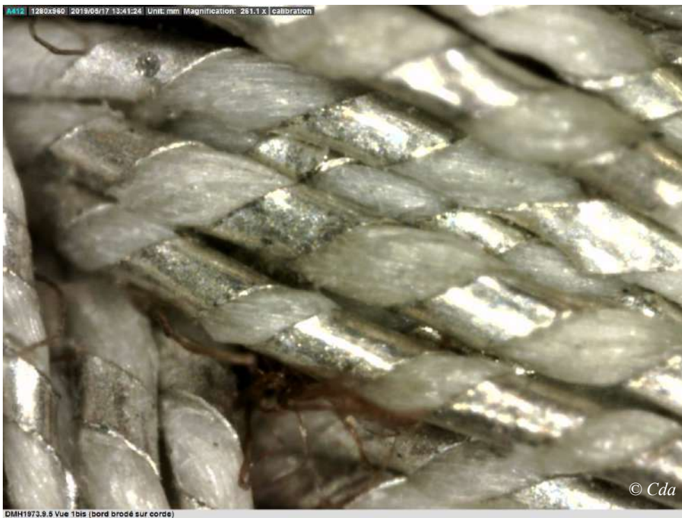
DMH1973.9.5 - Vue 1 - Tresse métallique à chevrons sur corde (261.1x)
