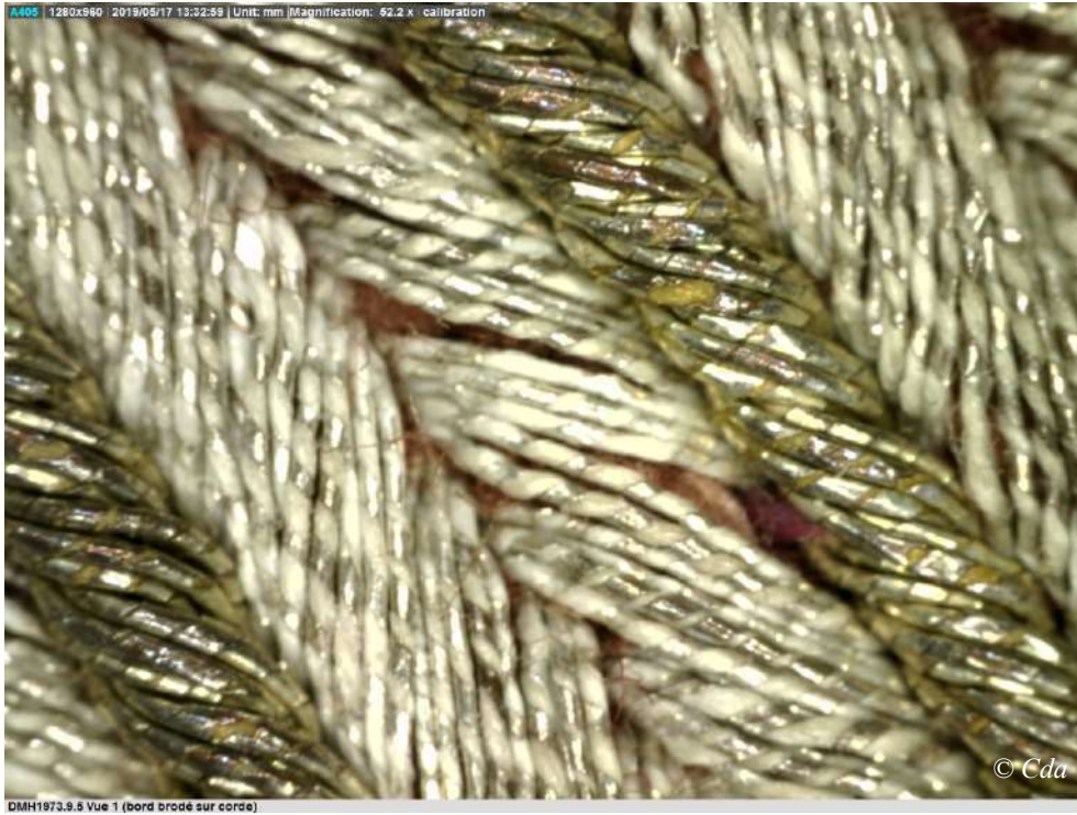
DMH1973.9.5 - Vue 1 - Tresse métallique à chevrons sur corde (52.2x)
