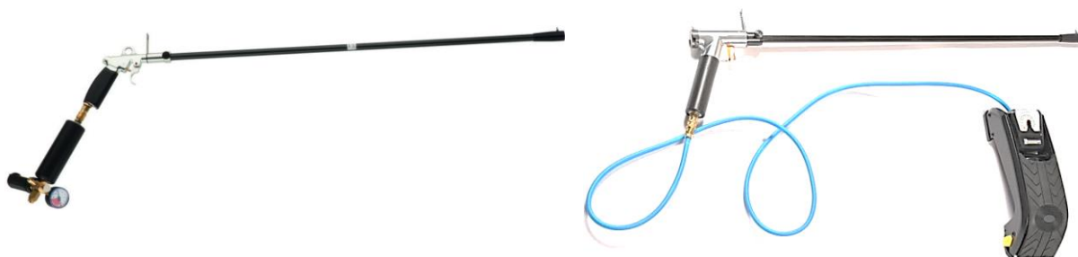
Figure 15 : Photo d'un pistolet hypodermique fonctionnant avec des cartouches CO 2 à gauche ou une pompe à pied droite (Telinject®)
