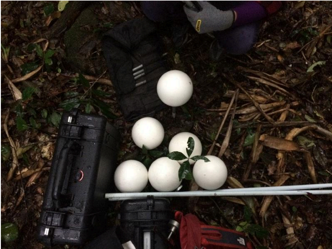
Illustration 7. Système de balles d'identification permettant la reconstitution digitale des différents scan dans un plan commun sur ordinateur.
