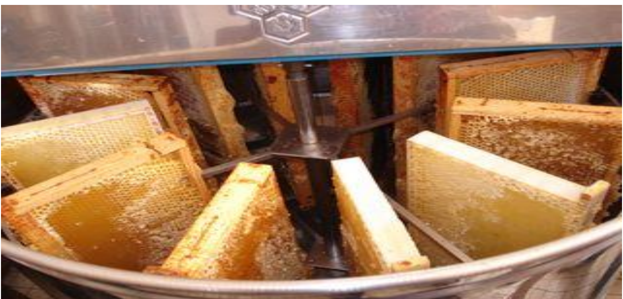
Figure 5 Extracteur dans lequel les cadres désoperculés sont déposés (15)
