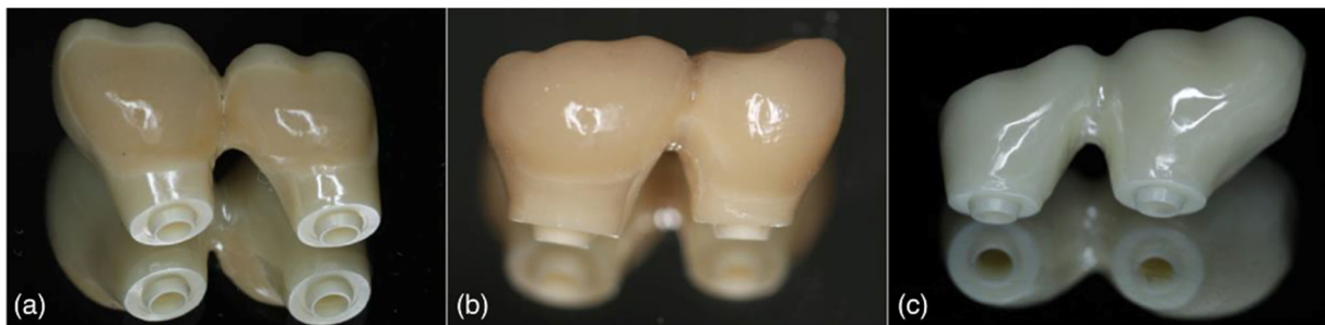
Figure 21 (a) Céramique partiellement stratifiée, (b) complètement recouverte, (c) zircone monolithique
