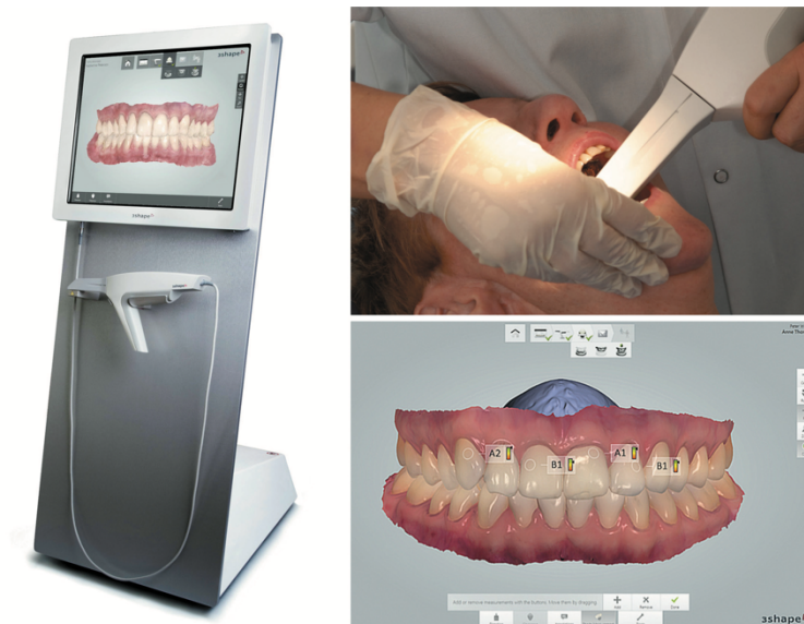
Figure 30 : prise de teinte par caméra optique TRIOS ® 3Shape
