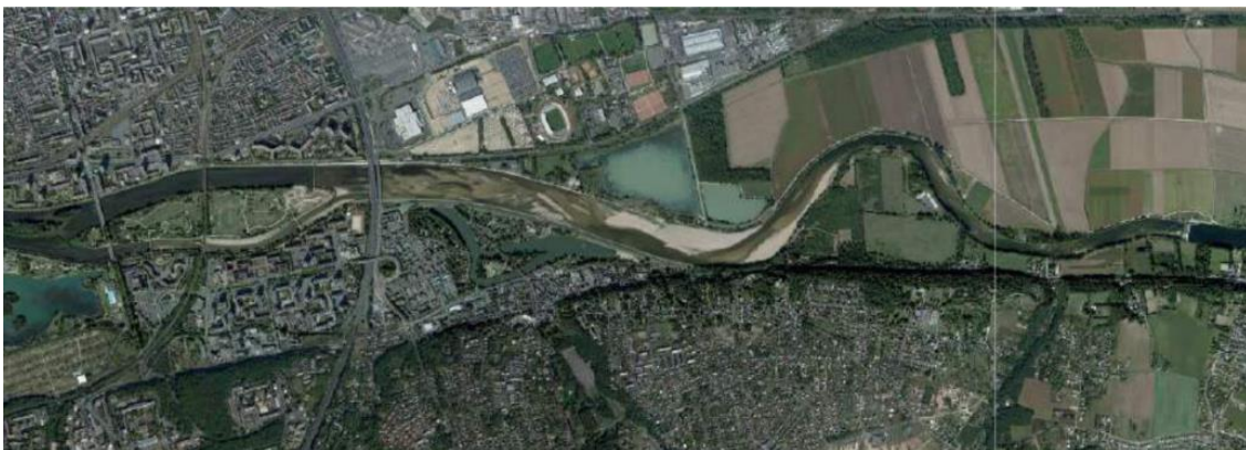
Figure 5. Ensablement en amont du plan d'eau de la Rochepinard sur le Cher recalibré, à Tours (Etablissement Public Loire, 2015).
