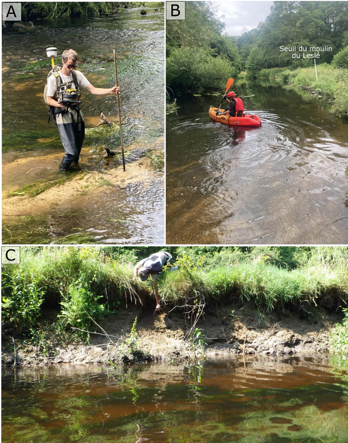
Figure 28. A. Relevé des points GPS par le premier opérateur à l'aide de l'antenne réceptrice R2 Trimble. B. Arpentage en kayak dans le secteur du moulin de Saint-Yves. C. Prospection de berges par le second opérateur dans le secteur Sainte-Anne.
