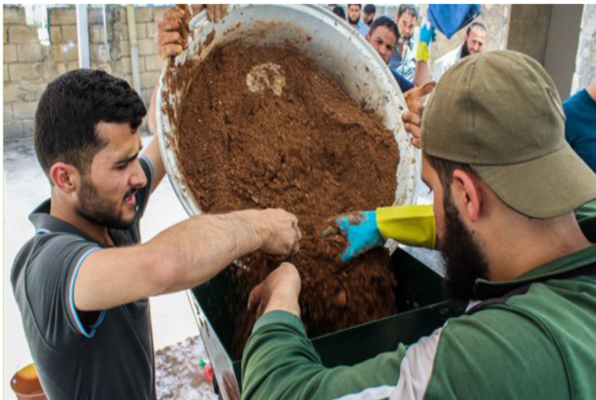
Figure 64 : Production de briques de terre comprimée lors de la formation professionnelle © Madad
