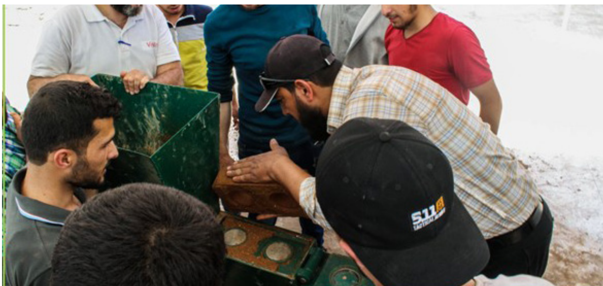
Figure 66 : Production de briques de terre comprimée lors de la formation professionnelle © Midad
