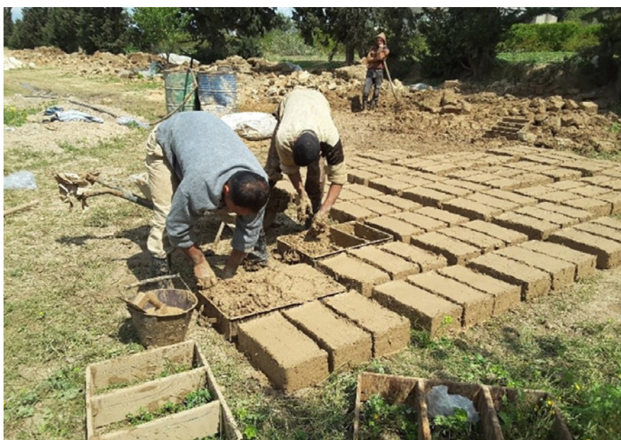
Figure 53 : La production d'adobe, Alfaroukia © Binaa
