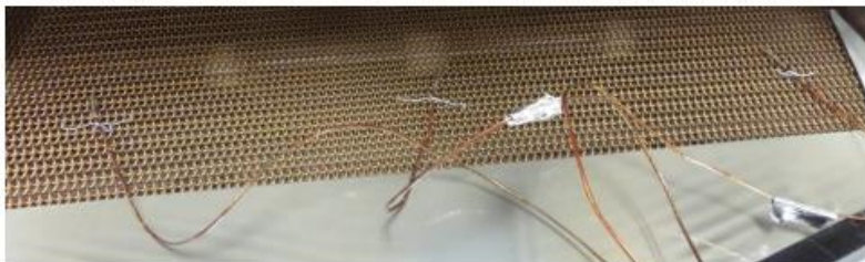
Figure 24 : fixation des sondes de la centrale KAYE
