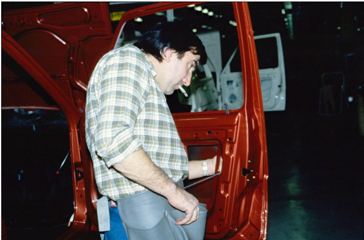
Photo étude Cnam n° 10 - Montage : assemblage de la porte
