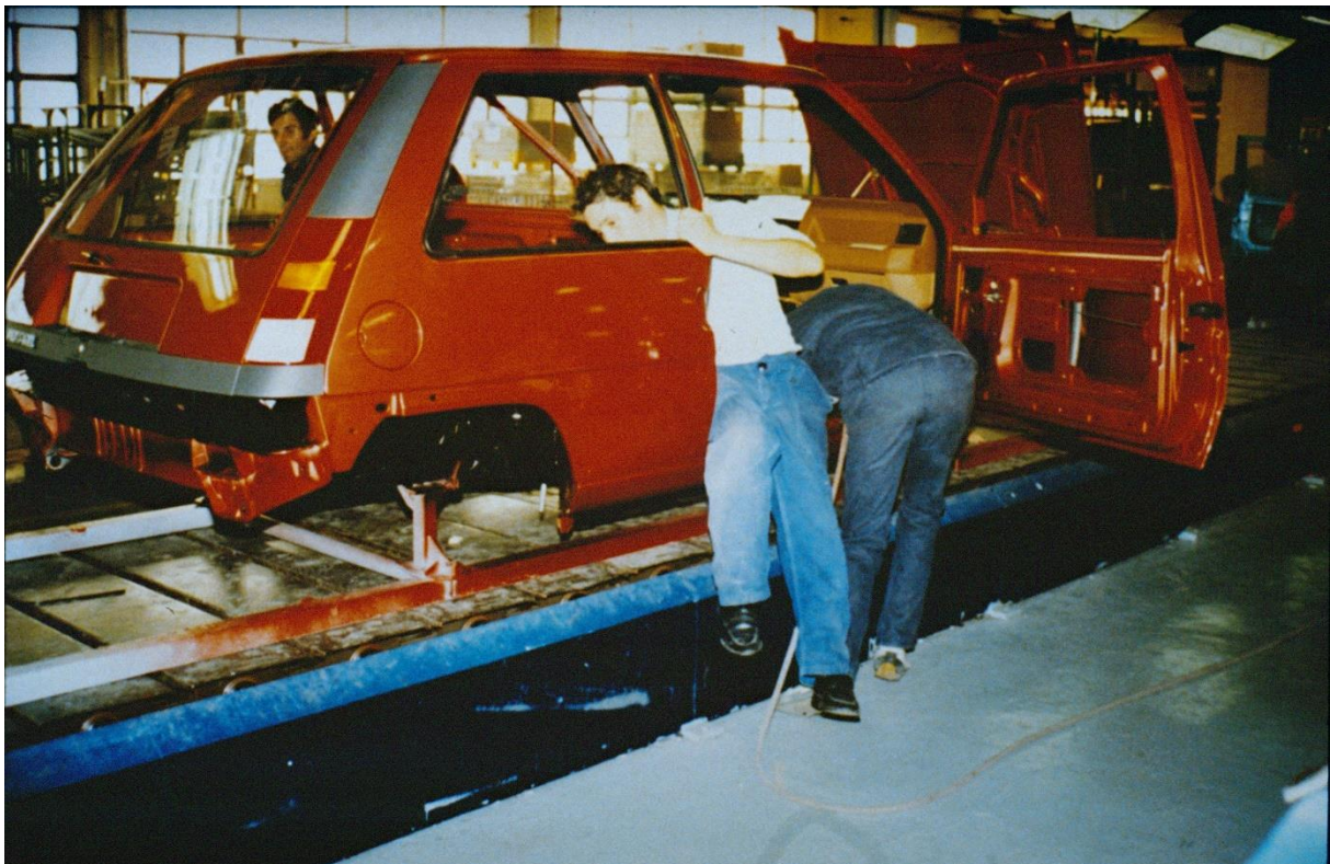
Photo étude Cnam n° 18 - Montage : habillage intérieur
