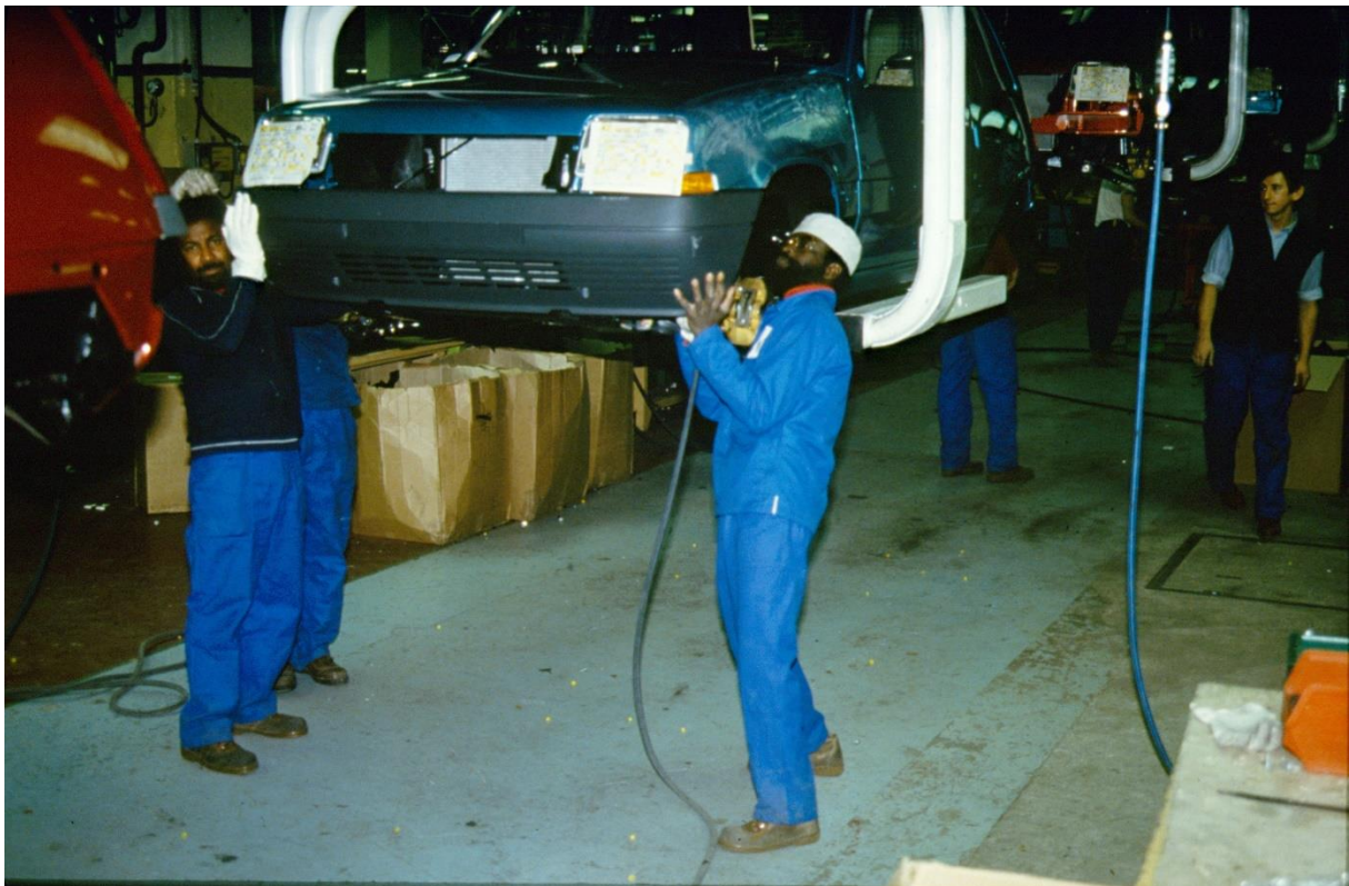
Photo étude Cnam n° 26 - Montage : Mise en place bouclier avant
