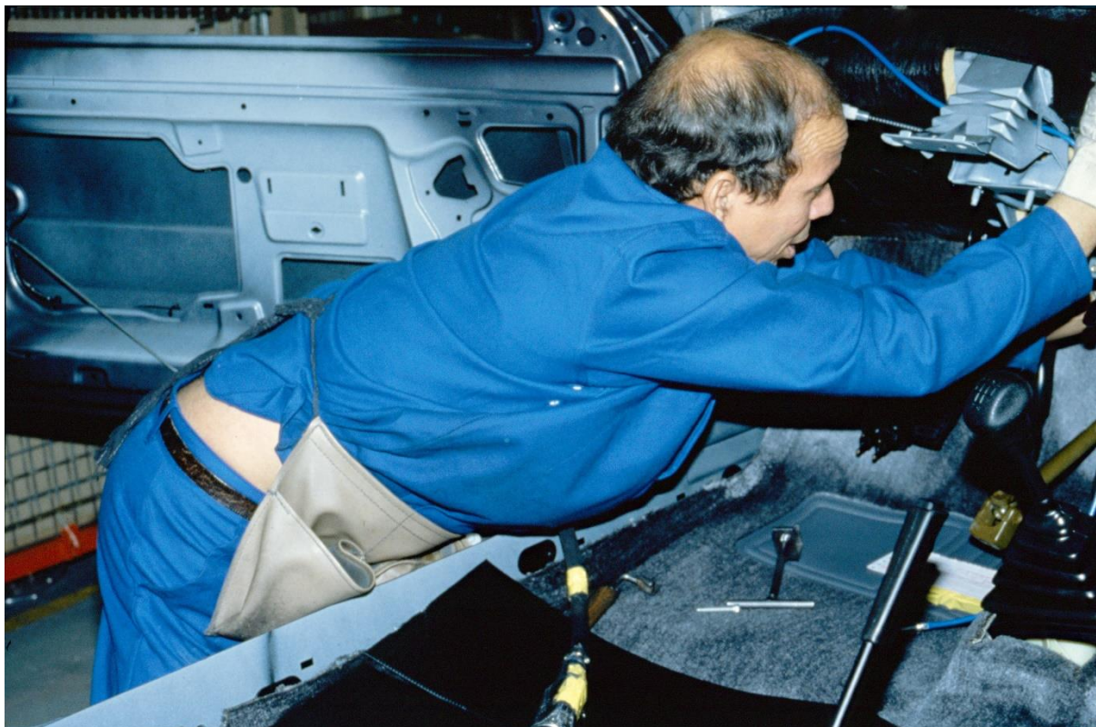
Photo étude Cnam n° 12 - Montage : préparation de la pose de planche de bord
