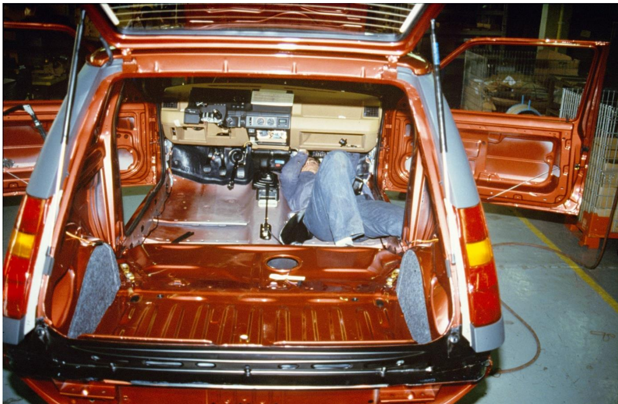
Photo étude Cnam n° 16 - Montage : câblage de la planche de bord
