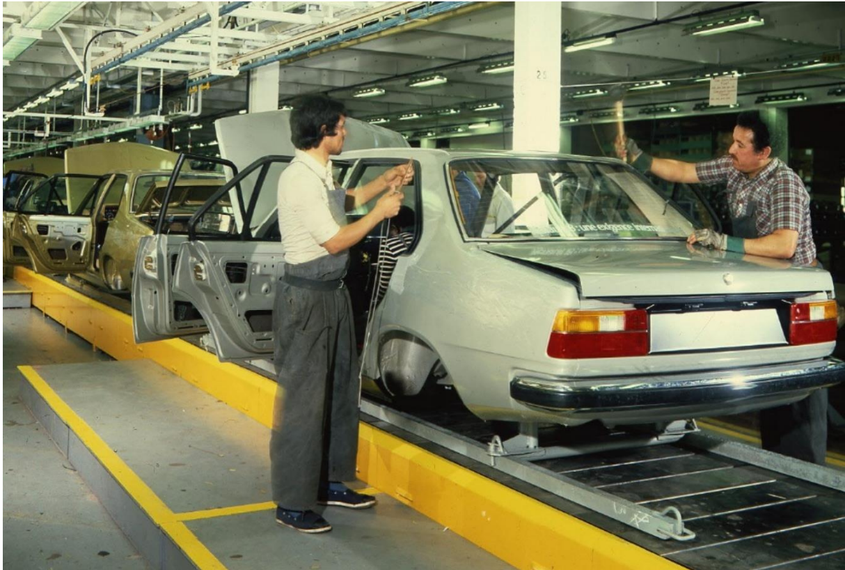
Evolution process n° 17 - Montage : pose du pare-brise arrière (Renault 18) - Circa 1983
