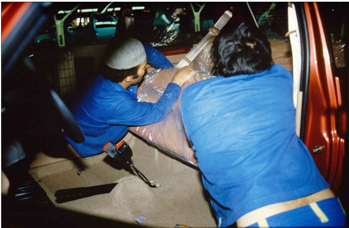
Photo étude Cnam n° 22 - Montage : mise en place de la banquette arrière
