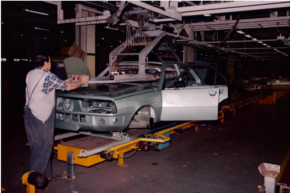
Photo étude Cnam n° 9 - Montage : pose de la garniture de pavillon (Renault 18)
