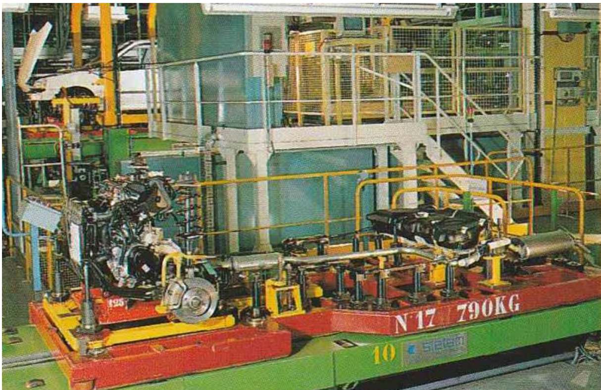
Evolution process n° 15 - Montage : Tronçon Mécanique Automatisé – TMA (SuperCinq) - Circa 1996
