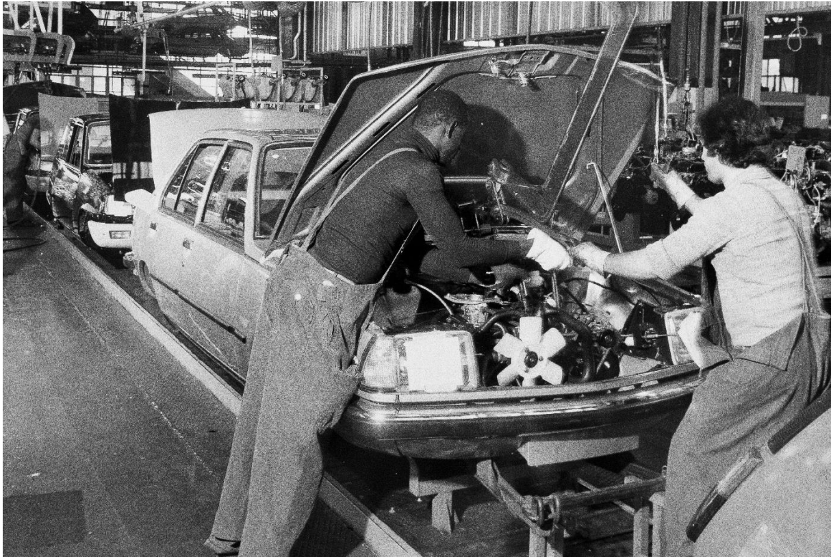
Evolution process n° 14 - Montage : mise en place du moteur avant l'implantation du TMA, (Renault 18) - Circa 1980
