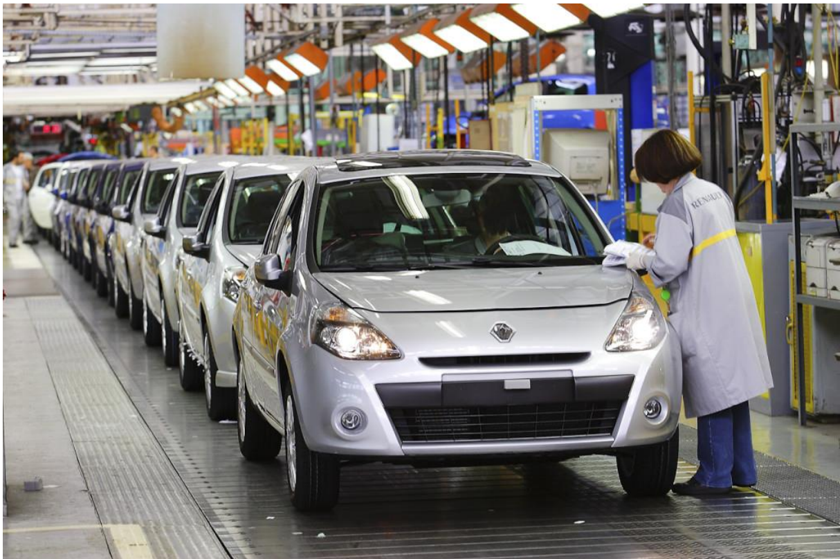
Evolution process n° 24 - Montage : contrôle qualité en bout de ligne (Clio 3) – Circa 2009
