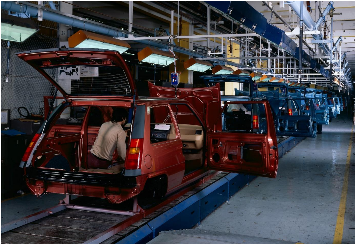
Evolution process n° 12 - Montage : mise en place de la planche de bord (SuperCinq) - Circa 1985
