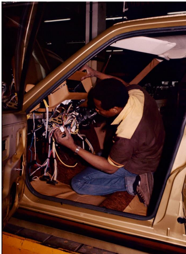
Photo étude Cnam n° 15 - Montage : câblage de la planche de bord
