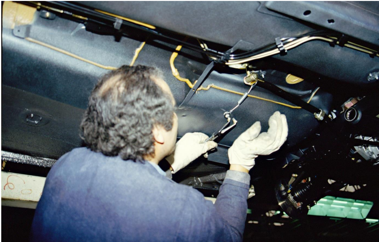
Photo étude Cnam n° 25 – Montage : clipsage de câblage « à la paume »
