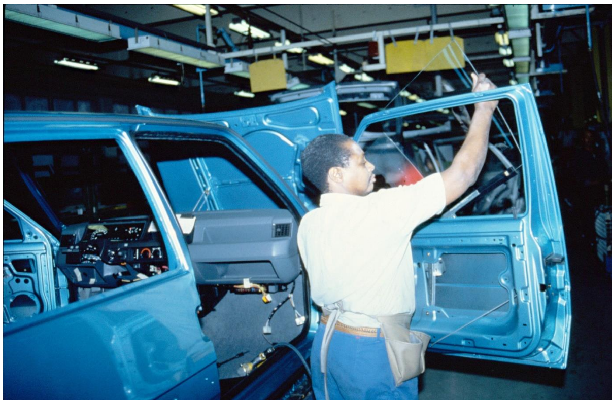
Photo étude Cnam n° 11 - Montage : pose de la vitre de porte
