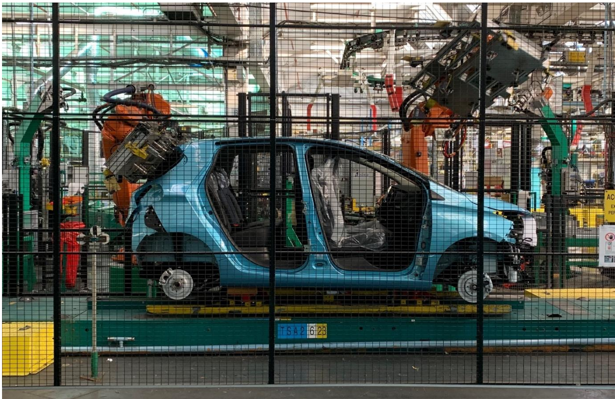
Evolution process n° 18 - Pose des parebrises avant et arrière en automatique (ZOE) – Circa 2020
