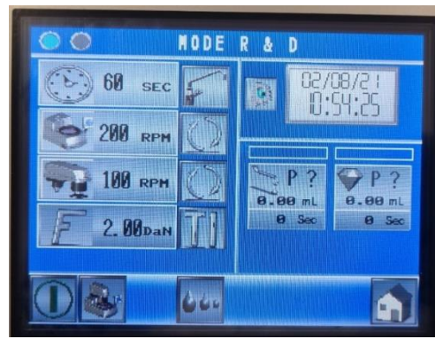
Figure 34 : Paramètres de polissage
