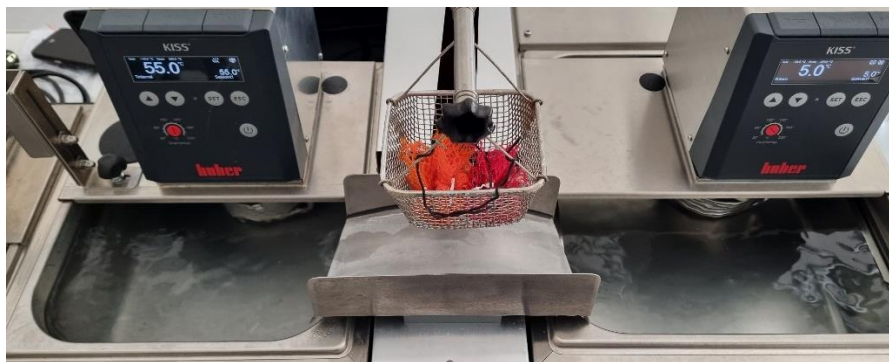
Figure 30 : Echantillons entre les deux bains de la machine de thermocyclage
