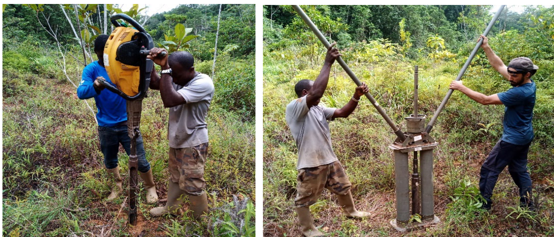
Figure 6 : Photo du marteau piqueur monté sur la gouge à gauche, photo du système d'extraction de la gouge à droite (photos personnelles)
