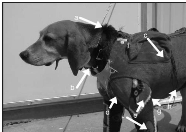
Figure 10 - Photographie d'un chien avec les huit différentes positions des capteurs d'accélérométrie (a=aspect dorsal du collier, b=aspect ventral du collier, c=aspect latéral du thorax, d=axillaire, e=aspect latéral de l'humérus, f=avant-bras, g=sternum, h=abdomen ventral) (50)
