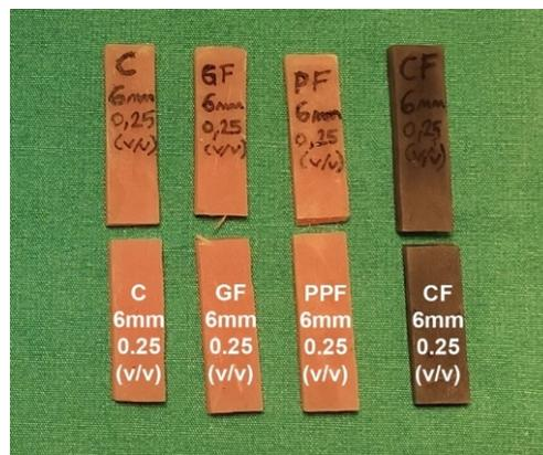
Figure12 : Éprouvettes après un test de flexion à 3 points (C : Contrôle / GF : Fibres de Verre / PF :Fibres de Polypropylène / CF :Fibres de Carbone) [24]
