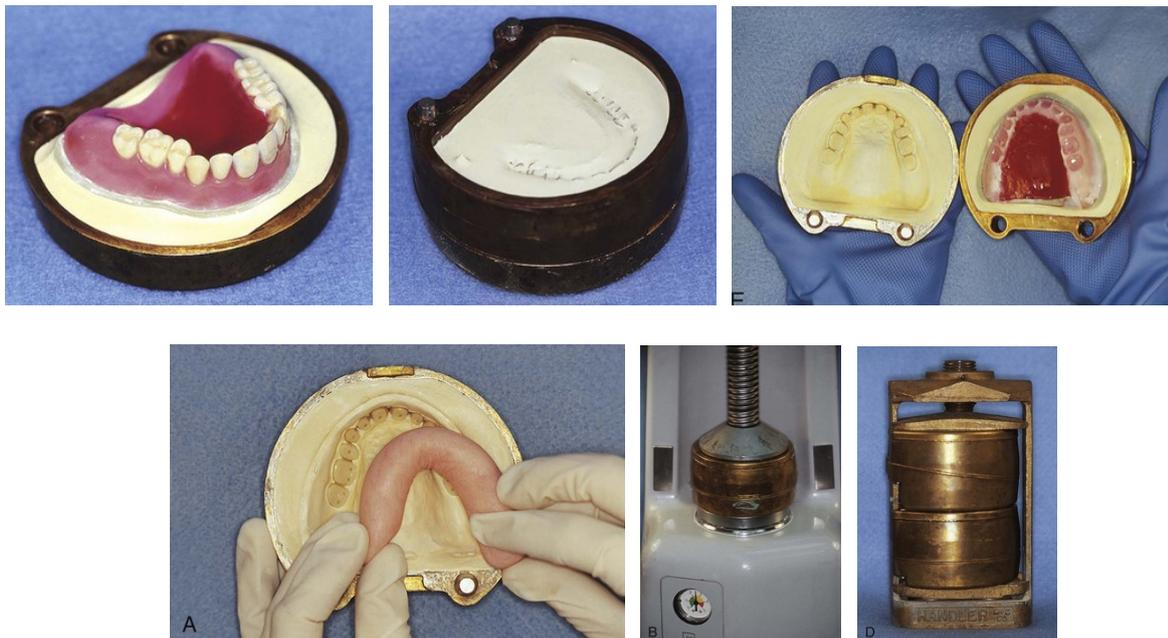
Figure 5 : Étapes de préparation de la technique de moulage par compression (site web : [pocketdentistry.com](http://pocketdentistry.com))
