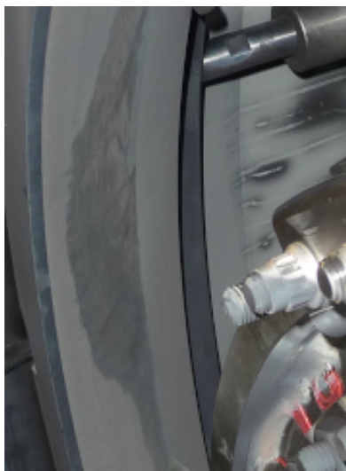
Figure 3.8 État du revêtement abrasable après l'essai de contact A5-E4. Des lobes d'usure sont visibles sur la piste abrasable.
