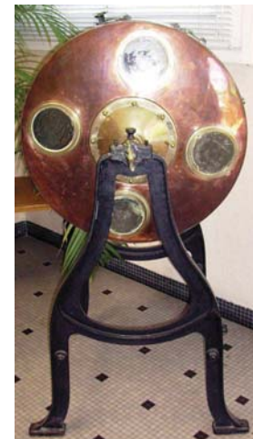
Figure 32: Calorimètre à chien
