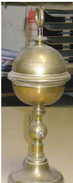
Figure 35: Hémisphères de MAGDEBOURG (Photographie A. Cugnasse)
