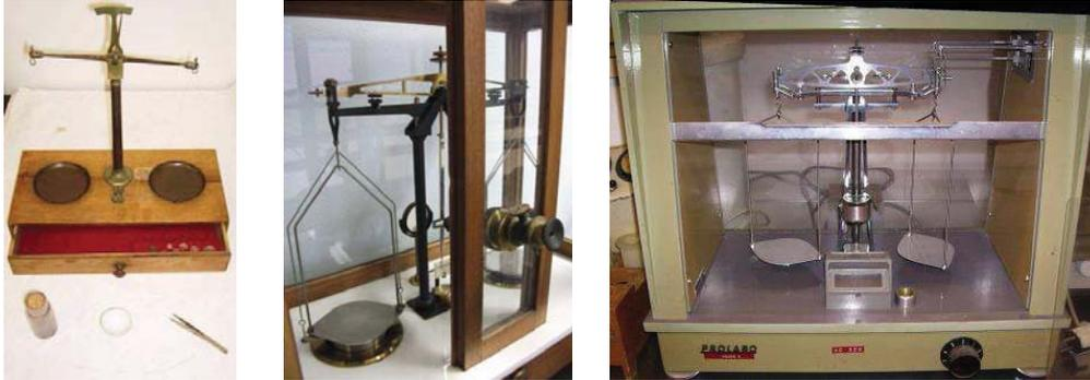
**Figure 41:** Balances, précision du gramme au 10<sup>ème</sup> de mg.
