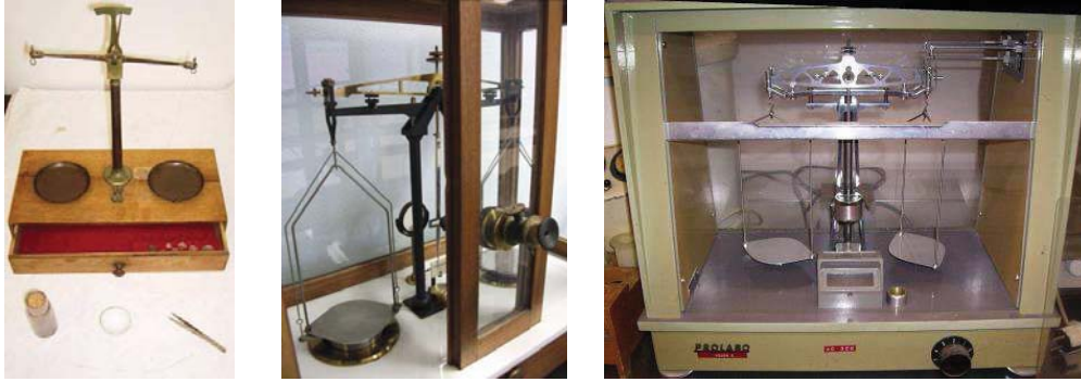
Figure 41: Balances, précision du gramme au 10 ème de mg.
