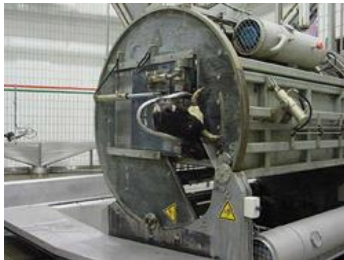
Photographie 5 : Cage à contention utilisée pour les bovins en abattage rituel (49)
