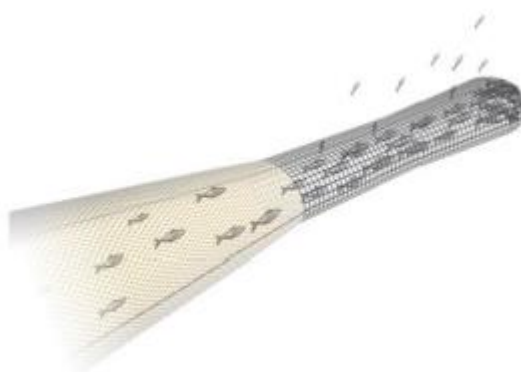
Figure 37 : Cul de chalut à mailles carrées (156)
