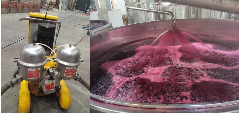
Figure 16 : remontage à la pompe (g), remontage automatique (d)
