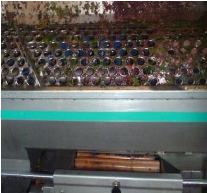
Figure 12 : Égrappoir couplé au fouloir
