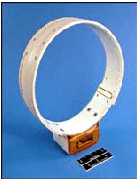
Figure 20 : photographies d'un collier émetteur standard (à gauche) et différentes variantes (à droite) : colliers équipés de systèmes de rupture automatique (B et D) et colliers extensibles (A et C) (55)
