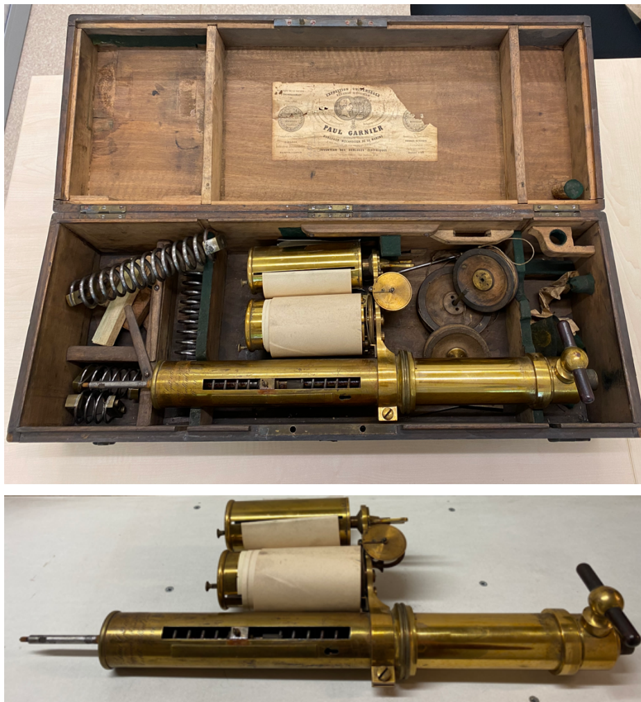
Figure 5-3 : Indicateur de pression de type Garnier (largeur du papier : 10,3 mm). Laboratoire de Thermodynamique de l'Université de Liège. Photos par l'auteur (Août 2023 et Novembre 2021).
