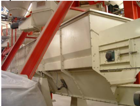
Photo 1 : balance à farine (2000kg), imprécision en kg (d'après photos de l'auteur)
