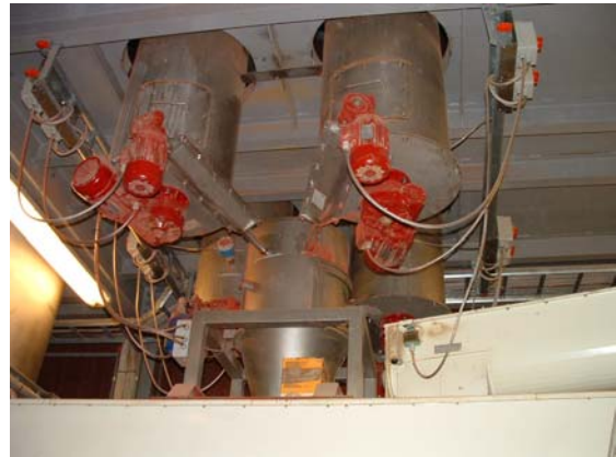
Photo 2 : balance à pigments avec imprécision 5g
