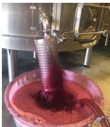
Figure 18 : Photographie d'un écoulage d'une cuve de vin rouge.
