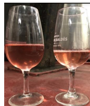
Figure 46 : Vin rosé avant (photo de gauche) et après (photo de droite) filtration sur terre.
