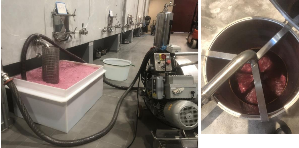
Figure 18 : photographies d'un remontage aéré. À gauche, le système mis en place, à droite le haut d'une cuve et l'aspersion réalisée.
