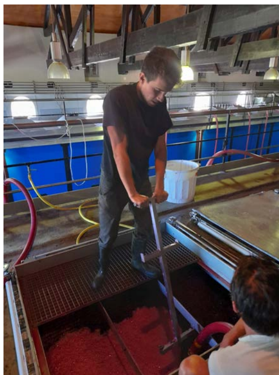
Figure 14 : Pigeage manuel à l'aide d'un matériel pour le pigeage
